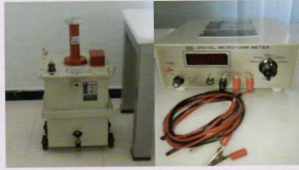
اي سی (AC) لور ولتاژونو آزمایښت سټ
